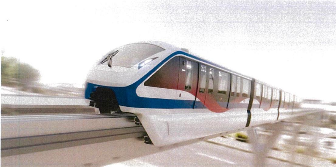
El material rodante consiste en una unidad de tren básico (BTU) bidireccional para varios carros. La configuración inicial es de cuatro (04) carros (A1-C1-D1-B1, ver figura). Los carros están conectados de forma semipermanente con enganches y pasillos, con dos puertas a cada lado del carro. Los carros de los extremos están equipados con acopladores automáticos abiertos.
